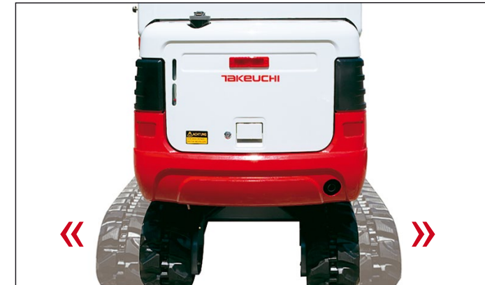
Raupenwerk mit hydraulischer Spurverbreiterung.
