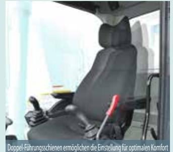
Doppel-Führungsschienen ermöglichen die Einstellung für optimalen Komfort
