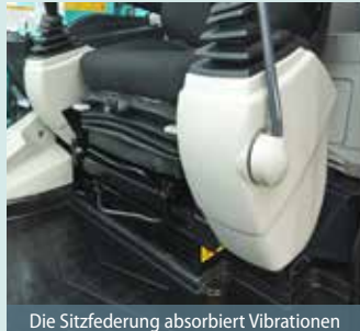
Die Sitzfederung absorbiert Vibrationen
