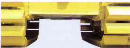
Halbschalenförmiger Hauptrahmen mit Flachbodenkonstruktion
