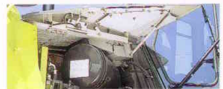
Weitöffnende Schwingtüren der Motorraumseitenverkleidung
