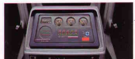
Elektronisches Anzeige- und Überwachungssystem
