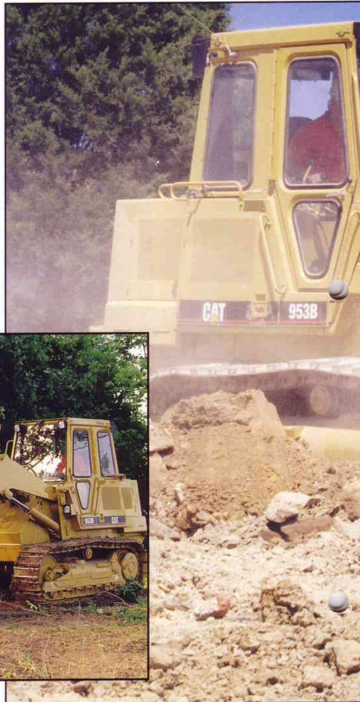
Ölgeschmierte Ketten ohne Innenverschleiß tragen maßgeblich zur überdurchschnittlichen Haltbarkeit des Laufwerks bei.
